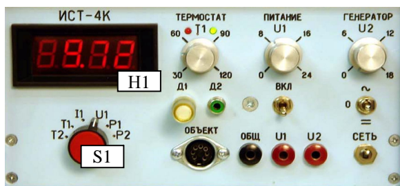
Рис. 9. Передняя панель комбинированного блока ИСТ–4К
