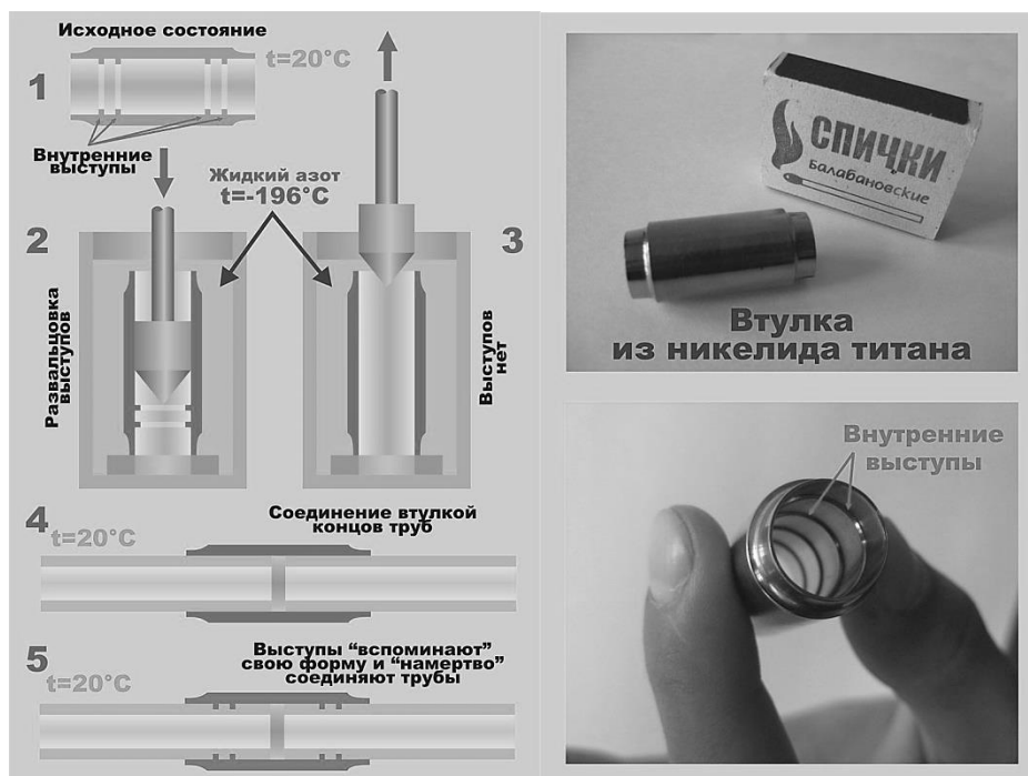
Рис. 39 Схема крепления втулки из TiNi[15]
