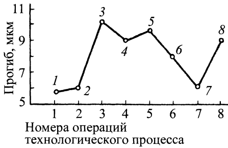
Рис. 8.88. Изменения стрелы прогиба пластины после различных технологических операций:
