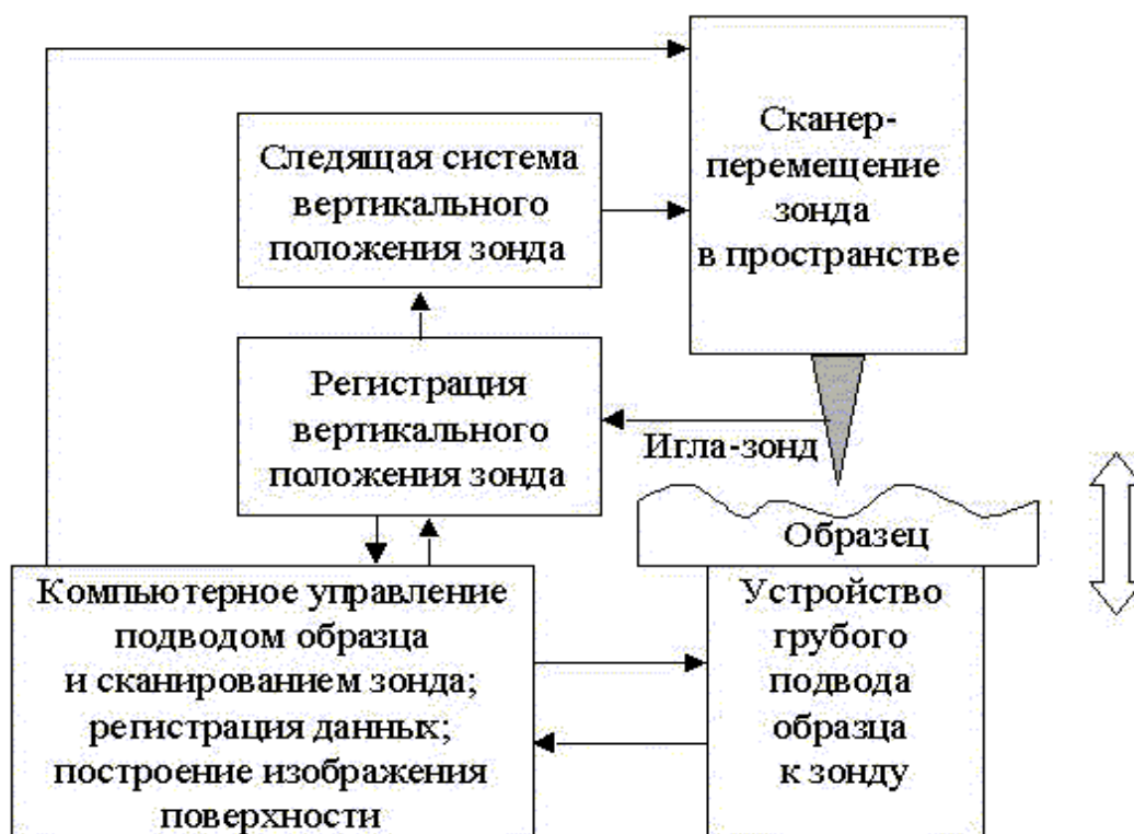
Рис. 9.1. Структурная схема сканирующего зондового микроскопа (для приборов, в которых сканирование осуществляется образцом)
