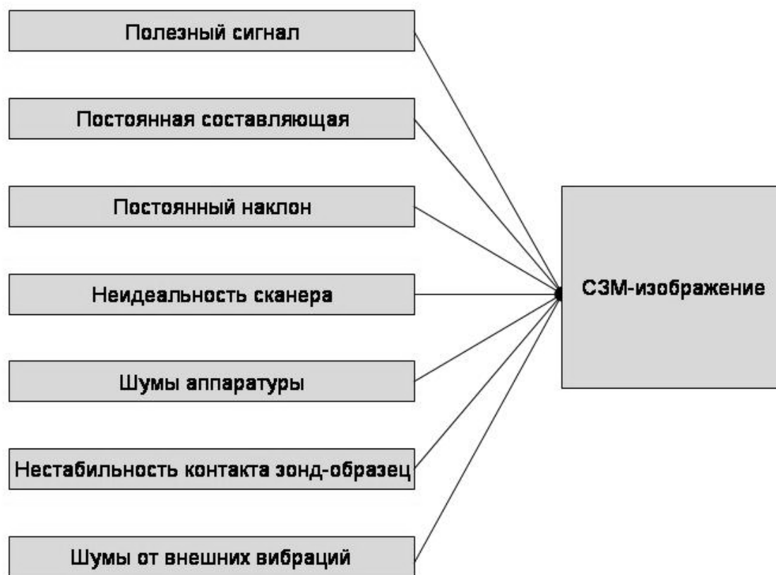
Рис. 9.29. Основные составляющие СЗМ-изображений без программной обработки
