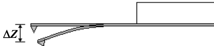
Рис. 9.13. Схематичное изображение зонда АСМ
