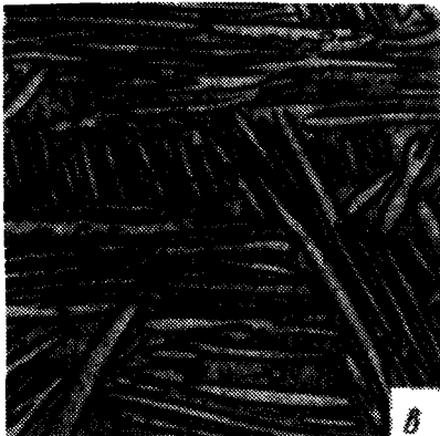
Рис. 361. Структуры титановых сплавов. \times 400 : а — твердый раствор \alpha (сплав ВТ1); б — фаза \alpha' (мартенсит, полученный после закалки сплавов ВТ1 с 1075 °С); в — твердые растворы \alpha+\beta (сплав ОТ4)
