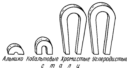
Рис. 383 Размеры магнитов из различных магнитных материалов одинаковой магнитной мощности
