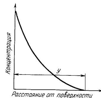
Рис. 254 Изменение концентрации диффундирующего элемента по глубине
