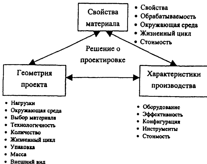
Рис. 42.1. Взаимосвязь между свойствами материала, геометрией проекта и характеристиками производства. Общая стоимость, масса и использование деталей в конструкциях определяются этими тремя проектными факторами
