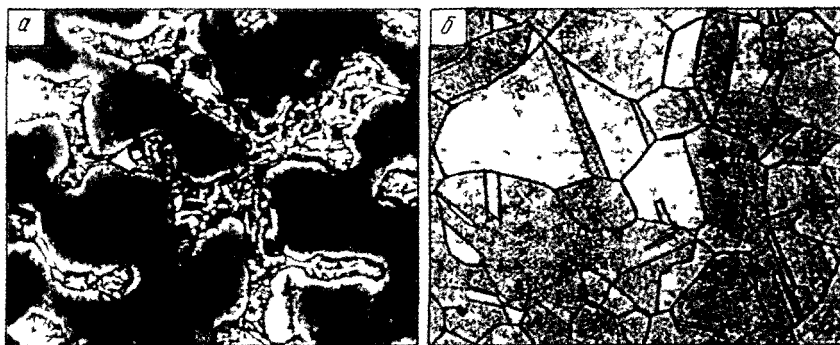
Рис 25.4 Микроструктура оловянной бронзы ( \times 200 )
