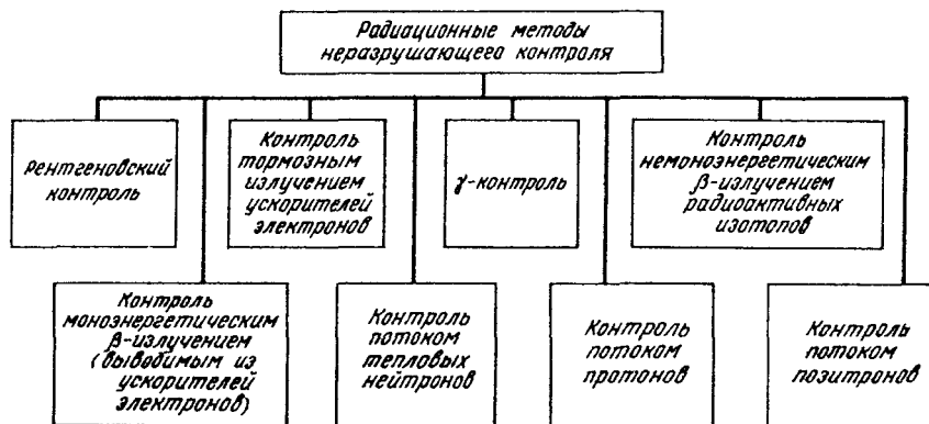
Рис. 3.44. Классификация радиационных методов неразрушающего контроля
