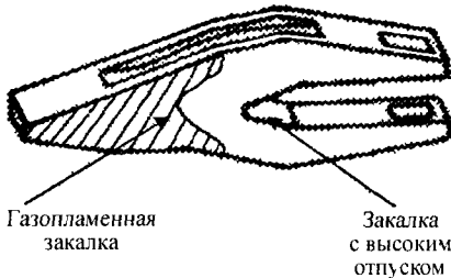
Рис. 43.4. Схема термической обработки зуба
