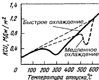
Рис. 11.12. Влияние температуры отпуска и скорости охлаждения после отпуска на ударную вязкость хромокремнистой стали
