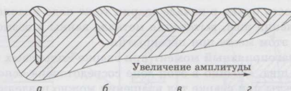
Рис. 2.14. Изменение характера проплавления при увеличении амплитуды поперечной осцилляции пучка:
