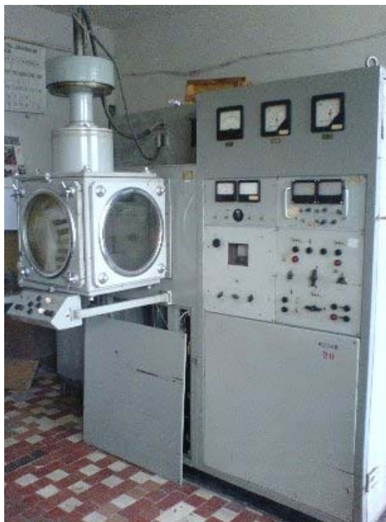
Рис. 8. Установка электронно-лучевой сварки типа А306.13
