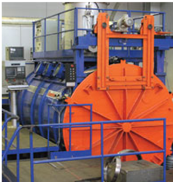
Рис. 17. Установка для сварки в автоматическом режиме деталей типа тел вращения
