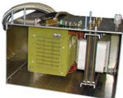
Рис. 21. Внешний вид высоковольтного источника
