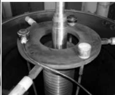
Рис. 3.43. Трехточечная подвеска для массивных деталей (до 1000 кг)
