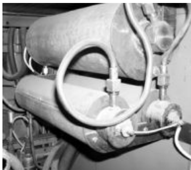
Рис. 3.45. Система очистки газовой среды
