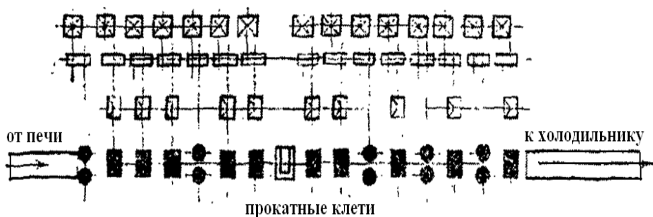
Рис. 5.16. Схема непрерывного прокатного стана
