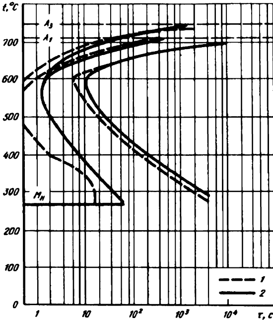
Рис. 78. Влияние бора на кинетику изотермического превращения аустенита в углеродистой стали с 0,63 % С и 0,87 % Mn [36]: 1 — 0 % В; 2 — 0,0018 % В
