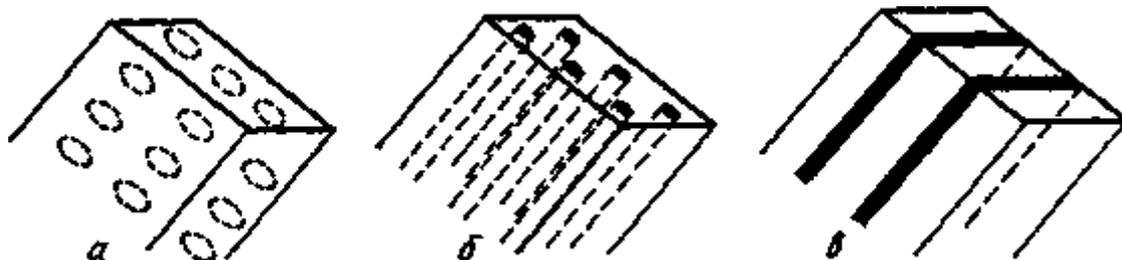
Рис. 1.1. Схемы строения композиционных материалов: а - дисперсноупрочненные; б - волокнистые; в – слоистые
