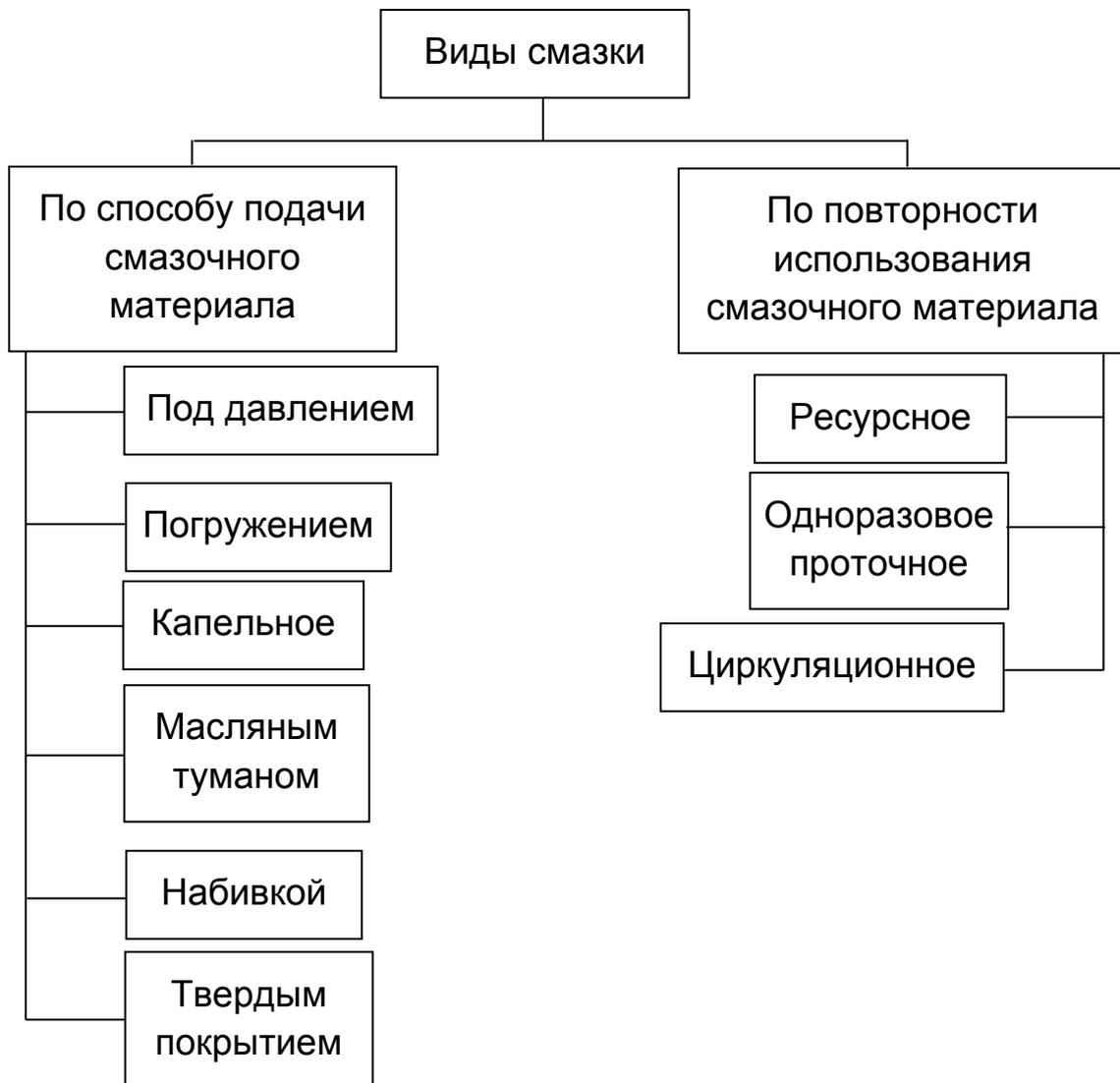
*Рис. 10.6. Способы нанесения смазочных материалов на поверхности трущихся тел*
