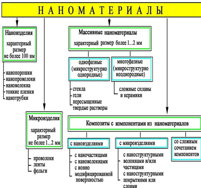
Рис. 2.2. Классификация наноматериалов
