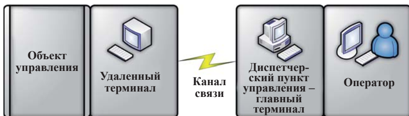
Рис. 2.4. Основные структурные компоненты SCADA-систем
