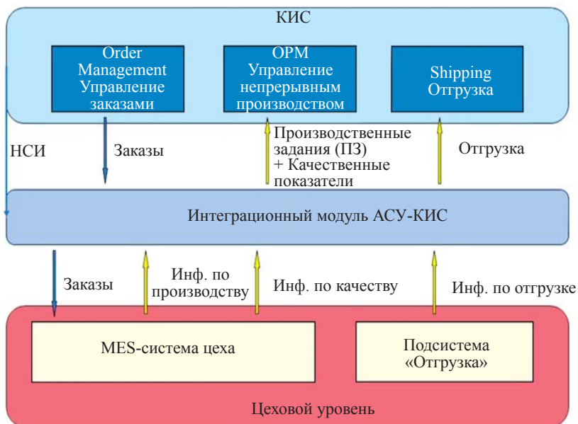
Рис. 9.1. Схема взаимодействия корпоративной информационной системы с системами цехового уровня
