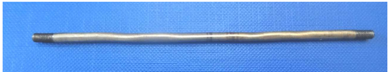
монокристаллический пруток Cu-14,5%Al-5%Ni
