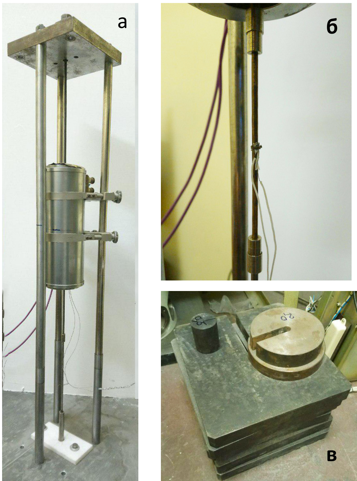
Рис.2.8. Специальная установка для растяжения образцов с эффектом памяти формы, где а – вид установки с опущенной печью; б – вид закрепления термопары (ТХК) на образце при поднятой печи; в – набор грузов.
