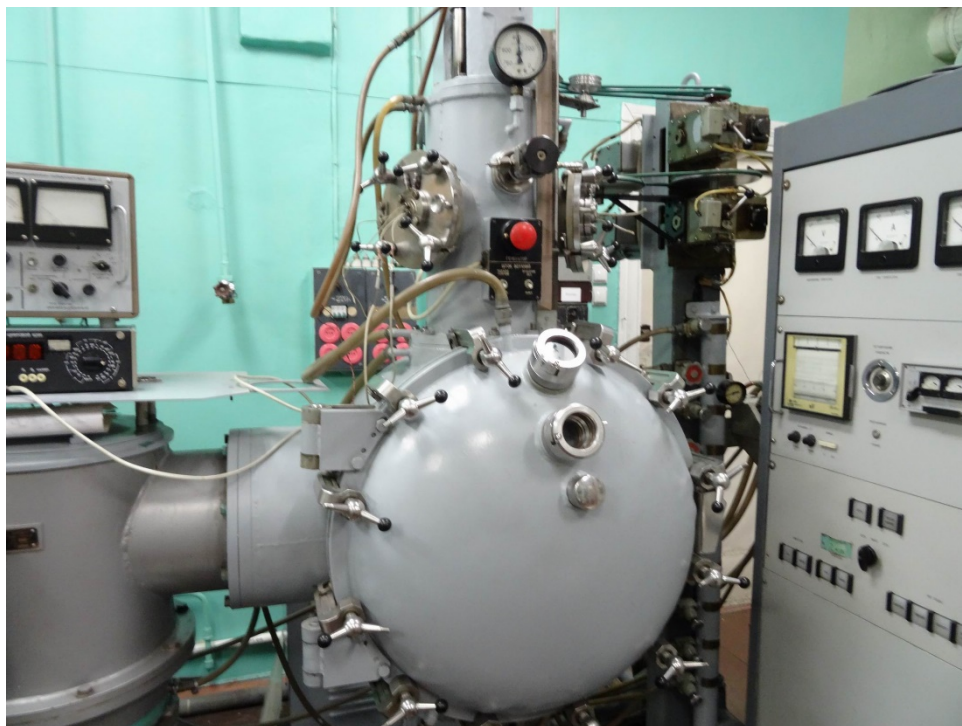
Рис.2.2. Установка «Донец» для вакуумной выплавки сплавов.
