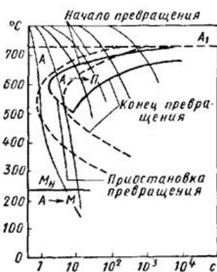
Рис. 33. Схема построения термокинетической диаграммы превращения аустенита
