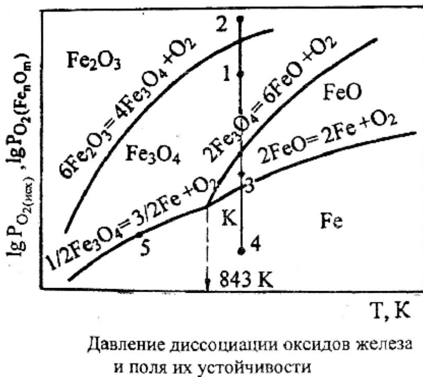
Рис. 1.8. Давление диссоциации оксидов железа и поля их устойчивости
