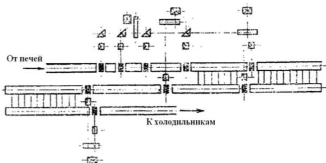
Рис. 5.18. Схема стана с последовательным расположением клеток на параллельных линиях
