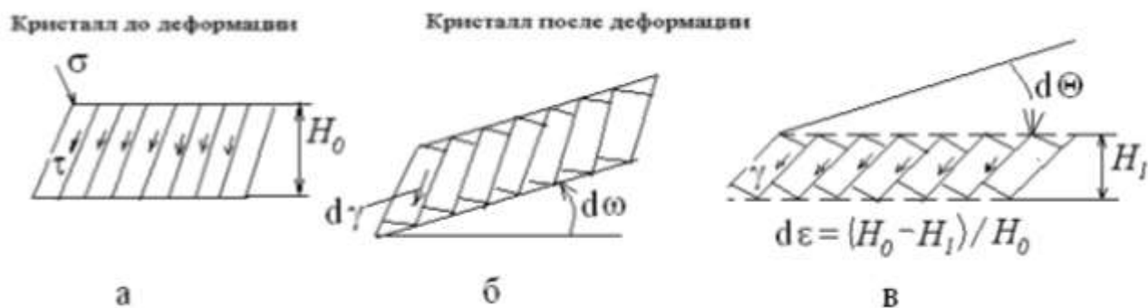
Рис. 18. Модель «домино»: сдвиги и повороты решётки при деформации: а – кристаллит с системами скольжения до деформации; б – поворот кристаллита в результате сдвигов по системам скольжения; в – поворот решётки в результате вынужденной внешней деформации.
