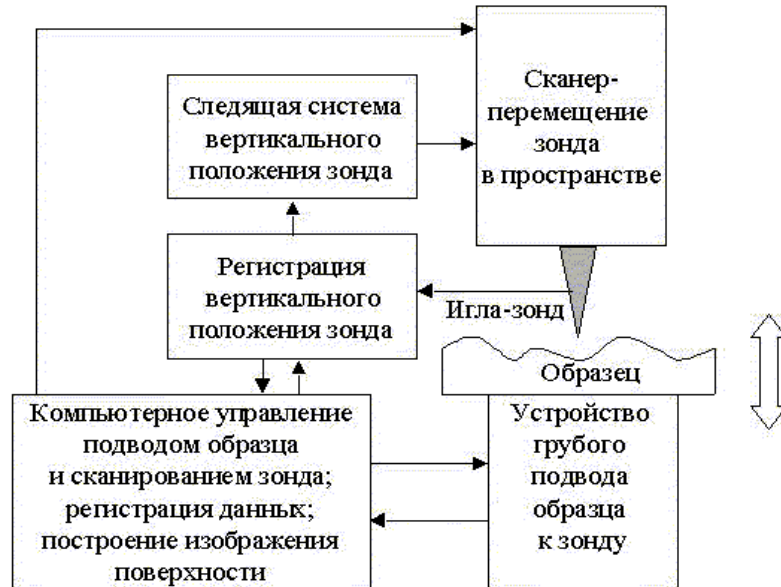
Рис. 6.1. Устройство сканирующего зондового микроскопа
