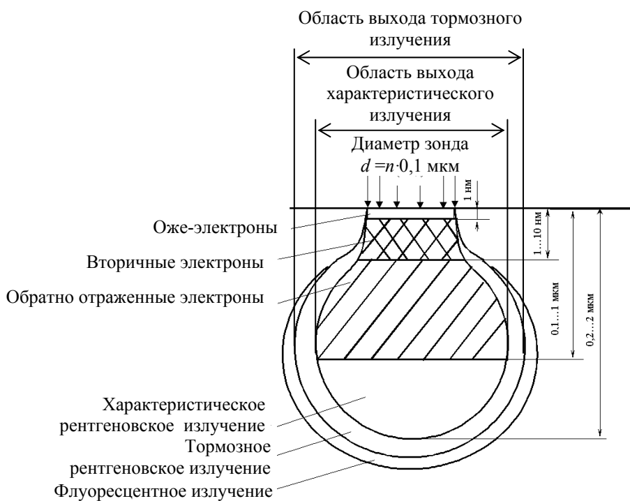
Рис. 5.2. Области возбуждения характеристического и тормозного рентгеновских излучений в образце
