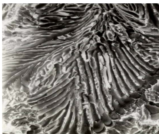
Рис. 4.10. Вид излома хрупкого материала во вторичных электронах
