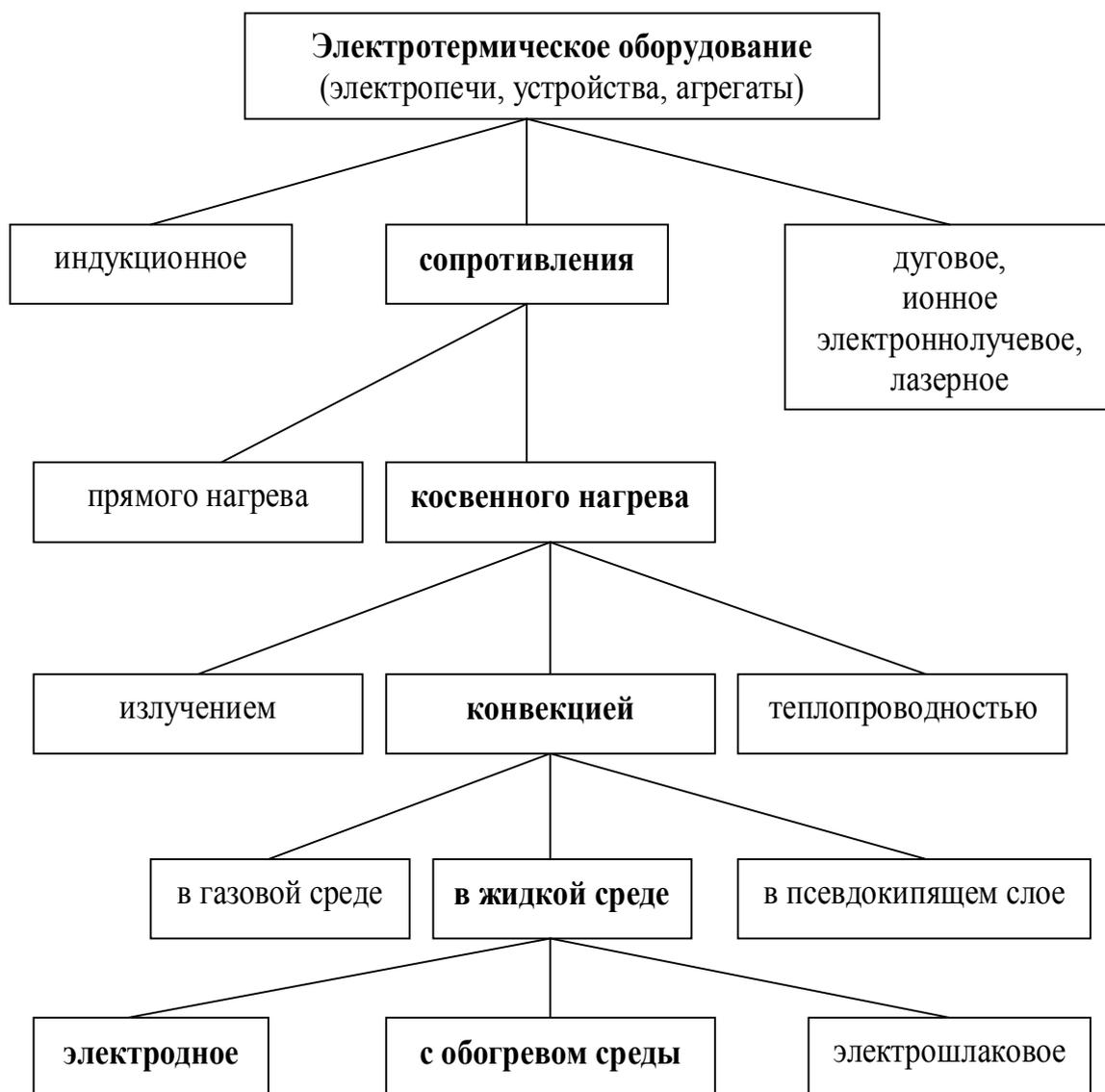
**РИС. 1 КЛАССИФИКАЦИЯ ЭЛЕКТРОТЕРМИЧЕСКОГО ОБОРУДОВАНИЯ**
